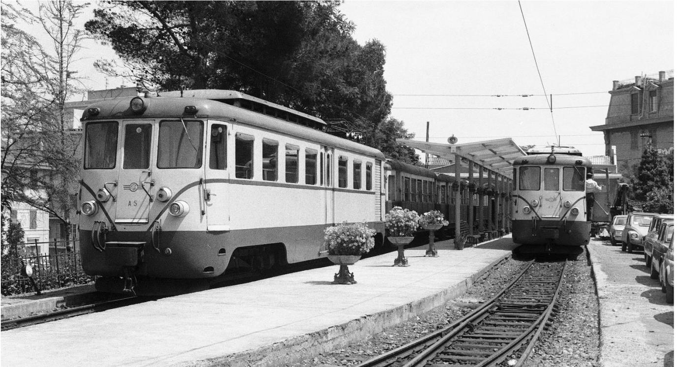
L: FGC Triebwagen A 5 (Bo'Bo') und R: A 7, beide der Reihe A 4 bis A 7 (ehemals SSIF Spoleto – Norcia, 950 mm-Spur) im Bahnhof Genova Piazza Manin. 📷 1979
