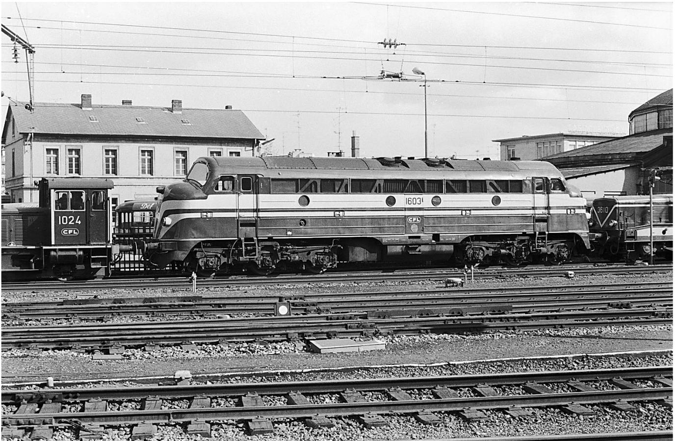
Die bullig wirkende Reihe 1600, eine sogenannte NOHAB \*-dieselelektrische Lok, Achsfolge Co'Co'. Links die dieselhydraulische Reihe 1020 der CFL. 📷 1975 in Luxembourg
