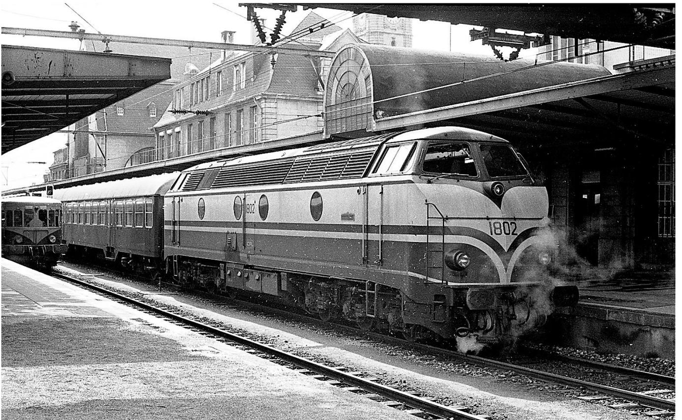
Vor dem Monumentalgebäude des Luxemburger Bahnhofs (in diesem Bericht kein Foto der Hauptfassade\*) steht die 1802 vor einem Nahverkehrs zug. Der Zug ist dampfbeheizt, was bei der Lok optisch gut erkennbar ist. Links ist ein „De Dietrich“-Autorail der CFL-Reihe 100 knapp zu erkennen. 📷 1975
