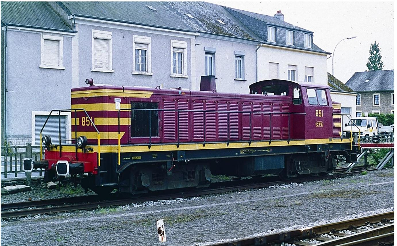
Sehr gut ist hier die Analogie mit einer BB 63000 der SNCF zu erkennen. Die Lok 851 der CFL steht hier im Bahnhof von Kleinbettingen. Achsfolge Bo'Bo', dieselelektrisch, Hersteller Brissonneau & Lotz 📷 1993
