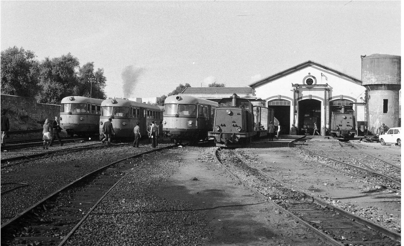
Links: Dieselmechanische TW der Reihe ADm, rechts: DE-Loks der Reihe LDe 500, aufgenommen vor dem Bw (Deposito) der SFS von Sassari. 📷 1973
