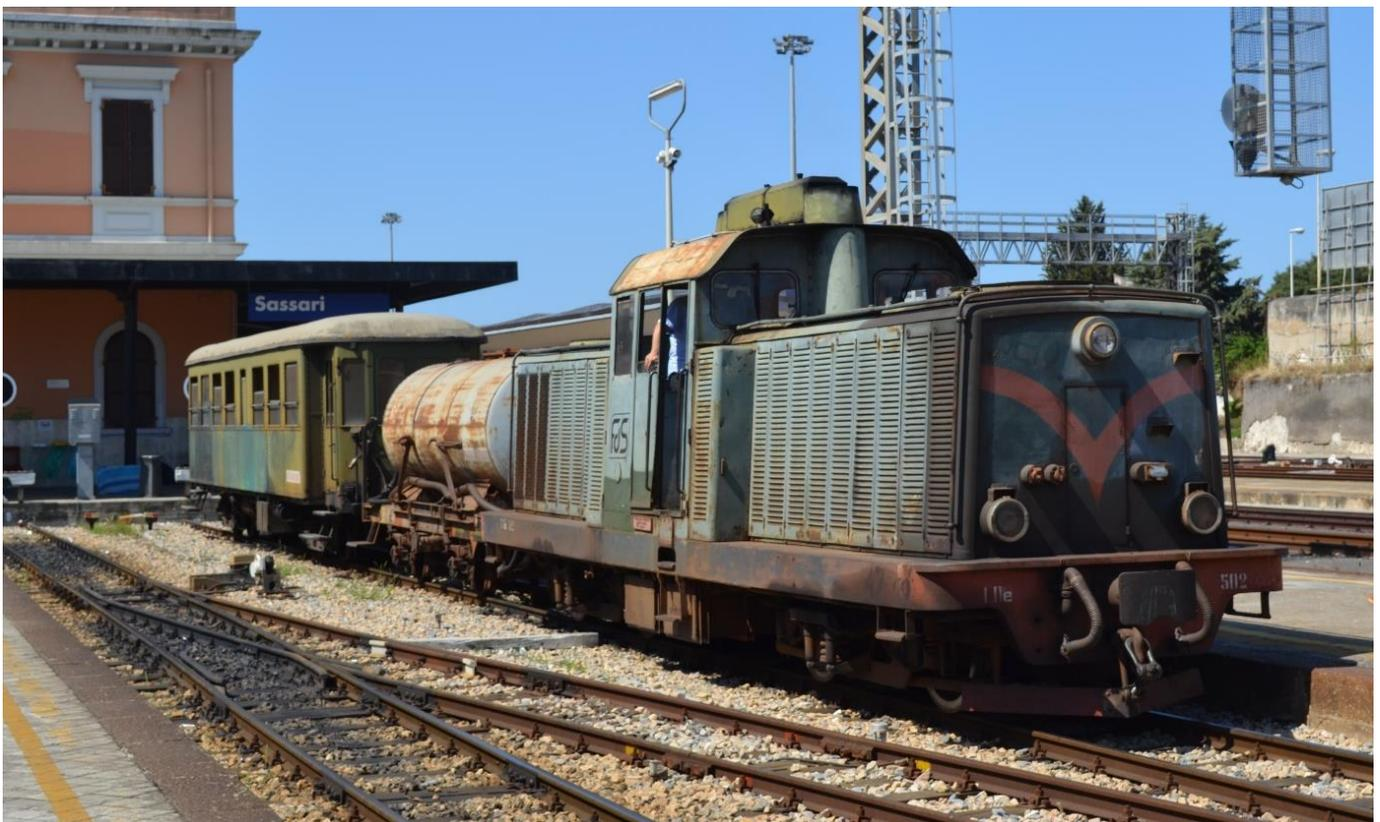
Die dieselelektrische Lok LDe 502 der FdS (Achsfolge Bo'Bo') steht in Sassari abfahrbereit mit einem Dienstzug. 📷 2011
