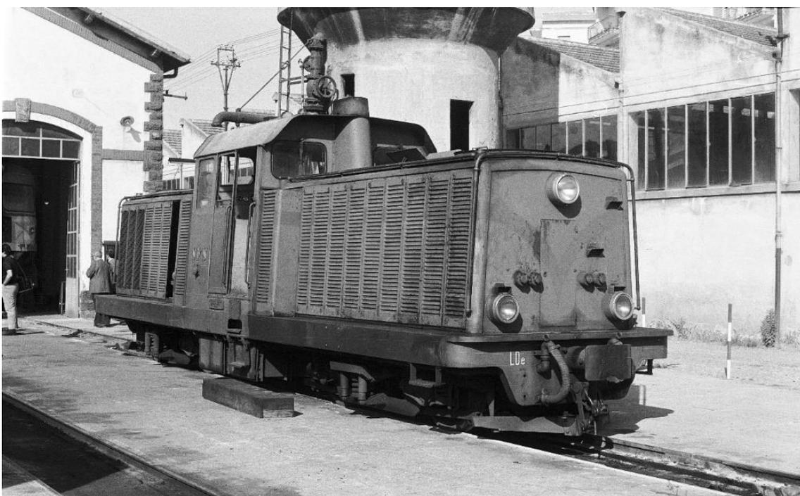
Eine diesel-elektrische Lok LDe 500 (Achsfolge Bo'Bo') steht im Bw (Deposito) von Sassari
