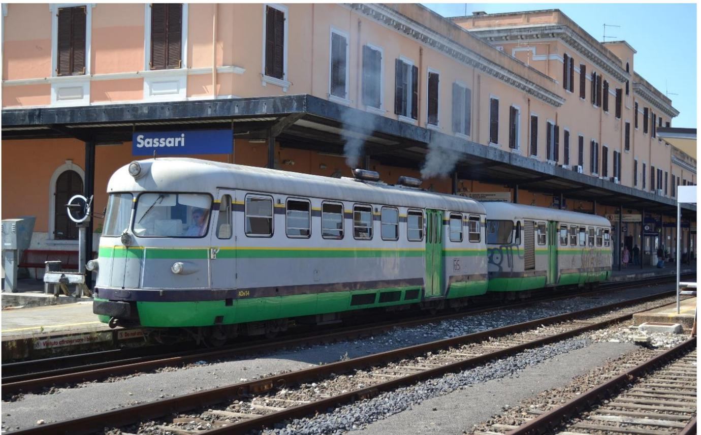
Dieselmehchanischer Triebwagen ADm 54 der FdS (Achsfolge B'B') mit Steuerwagen verlässt den FS-Bahnhof von Sassari auf Dreischienengleis in Richtung Nulvi. 📷 2011
